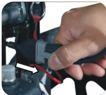
5. 將上控制器線接頭拆離轉接線接頭
