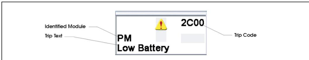
當控制系統的安全電路被啟動,輪椅會被禁止操控且類似下列診斷畫面會顯示,此畫面顯示系統之故障碼,即R-net已偵測出於輪椅電機系統之問題點(包含故障碼Trip code,被確認之模組Identified Module,故障原因Trip text)。
