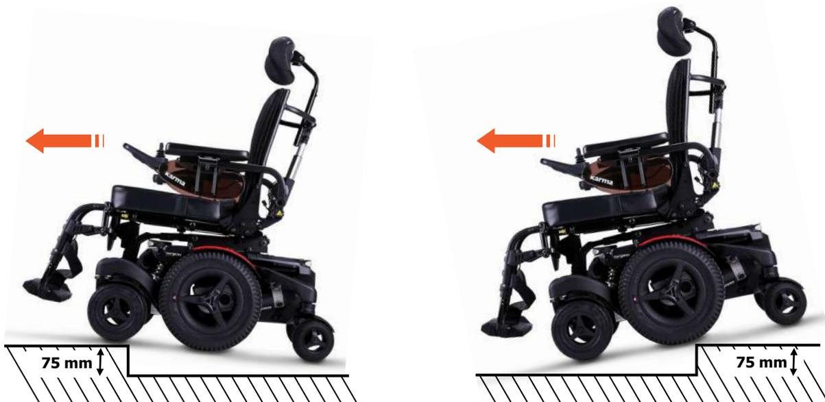
從較高的表面 (例如人行道) 朝下行駛時，請隨時注意輪椅是否突然向前急衝。如果您的輪椅具備電動座椅空中傾倒功能，您可以在人行道上行駛時使用座椅空中傾倒功能來提高穩定性。
