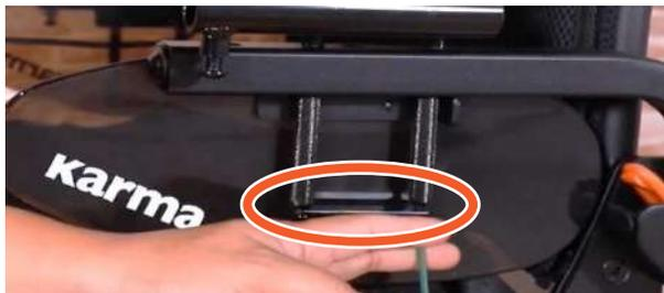
步驟 2：使用 5 公釐 (mm) 內六角扳手鬆開高度調整螺栓 (如下圖所示)。
