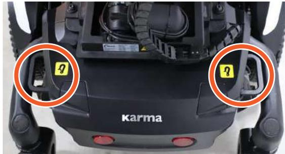
底盤後方的安全緊固點：後方掛勾，左右對稱
