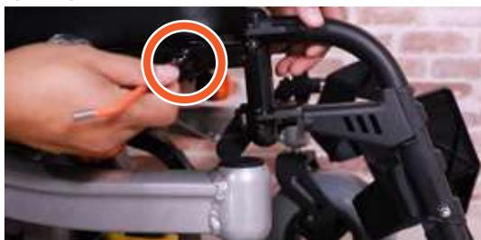
步驟 2：拉出或推入撥腳外掛座，然後找出最適合使用者的安裝孔。
