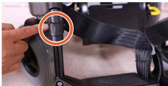
步驟 2：調整踏板高度並重新鎖緊螺栓和螺帽。踏板現已設定為不同的位置。
