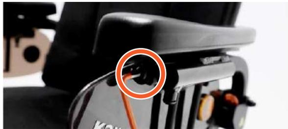
步驟 2：將扶手調整至適當的高度，然後重新鎖緊螺栓。扶手現已設定為不同的高度位置。
