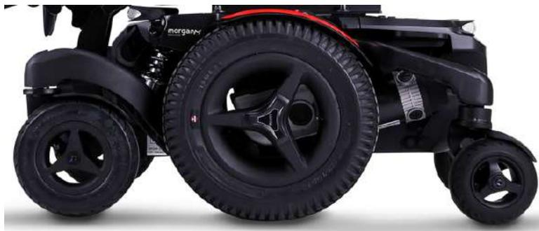
每顆驅動輪均由強大的驅動馬達所推動。這些馬達也負責控制輪椅的轉向。輪椅可透過此系統立即啟動，此設計可讓輪椅最適合在室內使用。
