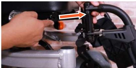
步驟 3：重新鎖緊螺絲。腳靠現已設定為不同的位置。
