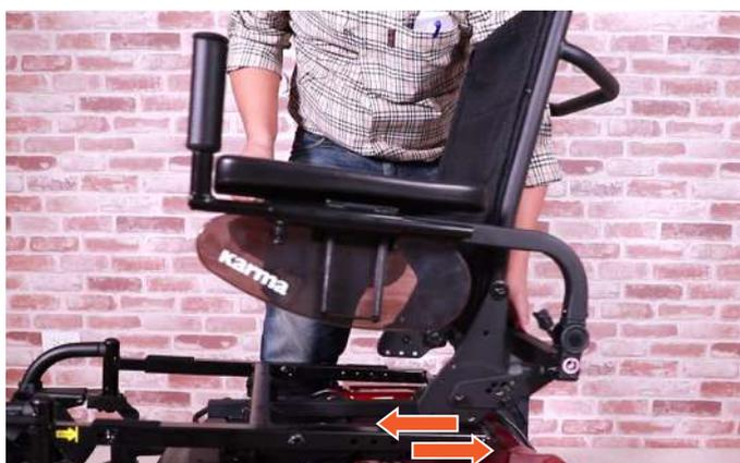
依照座深對照表，調整座深後鎖固 (所需工具：5 公釐 (mm) 內六角板手、#13 開口板手)。
