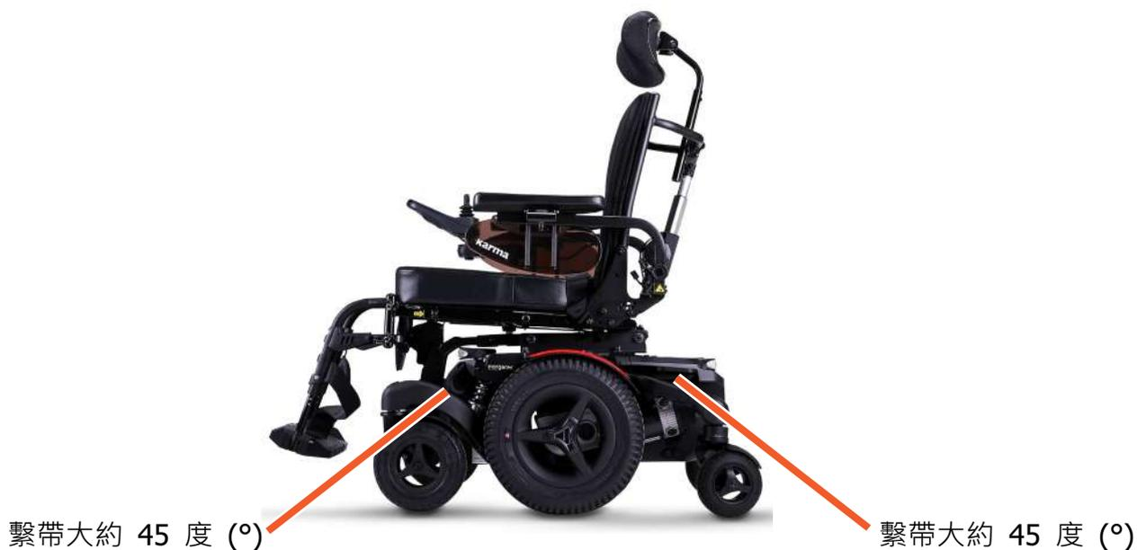
必須將繫帶連接到機動車輛的適當固定點。胎壓必須是在建議的數值範圍內，如此才能讓繫帶發揮最大效用。必須確保繫帶有妥善拉緊以確保安全性。
