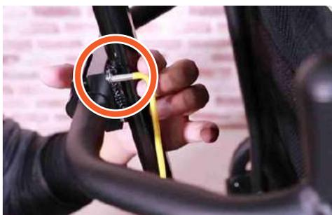
步驟 2：使用 4 公釐 (mm) 內六角扳手調整頭靠骨架的高度。
