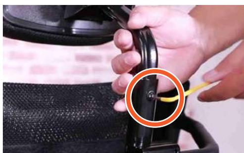
步驟 3：使用 5 公釐 (mm) 內六角扳手調整頭靠角度。
