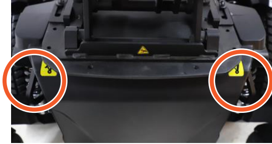
底盤前方的安全緊固點：位於前轉向輪上方，左右對稱
