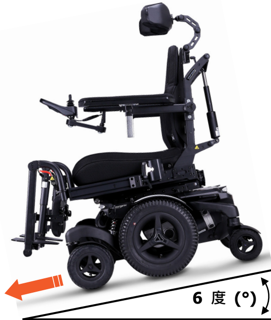
最大允許下坡坡度
